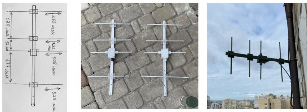
Рис.3. Виготовлення і встановлення антен радіомосту.
