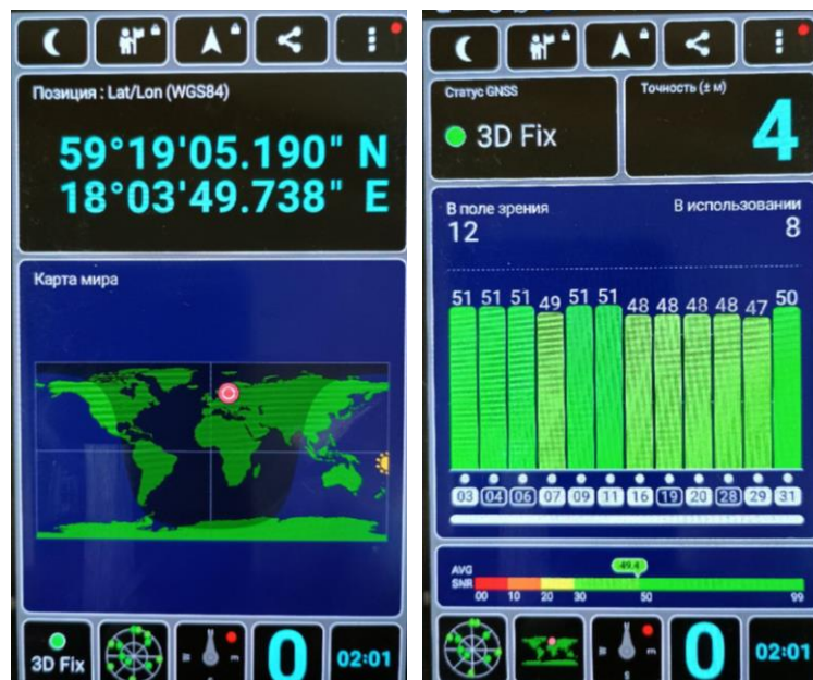
Рис.4. Результати тестування приймачів сигналів ГНСС GPS: а) U-blox; б) Motorola.
