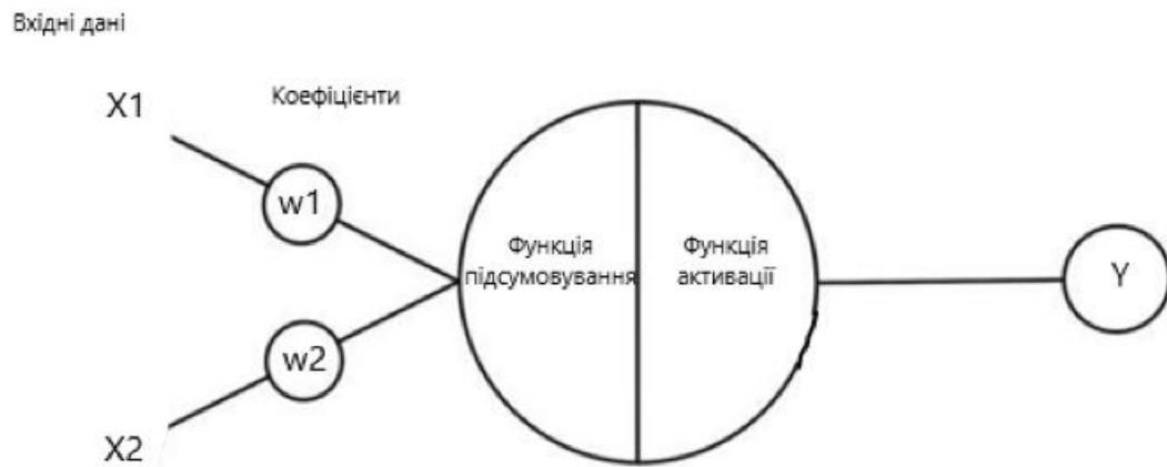
Рис. 1. Схематична модель одношарового перцептрону.
